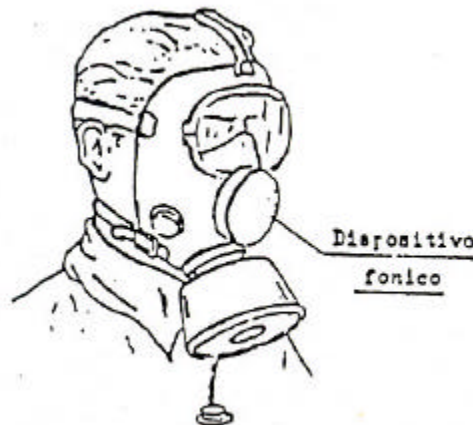
(Fig. 4 – Maschera antigas a filtro provvista di dispositivo fonico).
